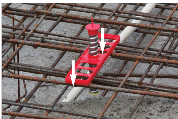
Montaje sencillo: la placa roscada se fija simplemente con alambre en la armadura. A continuación se puede ajustar la altura.
