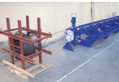
Dib. 20: Lanzacables eléctrico con mesa de estirar cable de 15 m
