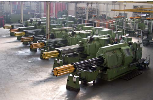
Dib. 3: Producción de anclajes de tensar con autómatas giratorias
