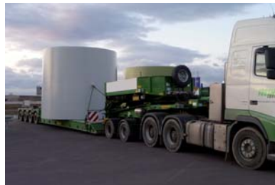
Dib. 25: Segmento de torre prefabricado durante el transporte
