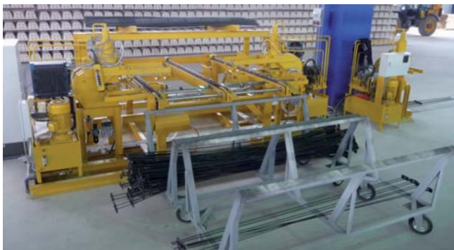
Dib. 26: Instalación remachadora controlado por CNC
