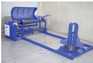
Dib. 21: Bobinadora de espirales de acero para armaduras de postes
