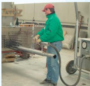
Dib. 9: Prensa de 4 mangueras 160 kN
