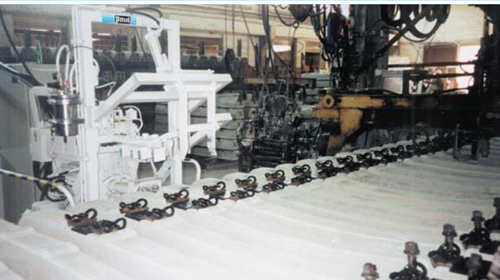
Dib. 29: Tensado de los alambres en cuerpos de traviesa ya fraguados
