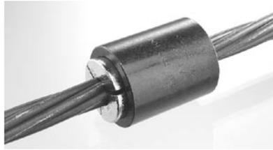
Anclajes abiertos son el tipo de anclajes más económico, robusto y utilizado. Su manejo y limpieza es sencillo y mayoritariamente se emplea en el lado de tensar. En combinación con prensas de tensar unifilares con émbolo de inyección hidráulico sólo tienen poco resbalamiento. También durante el proceso de destensado, su manejo es muy sencillo. A menudo, anclajes abiertos se emplean también como anclaje de postensado.
