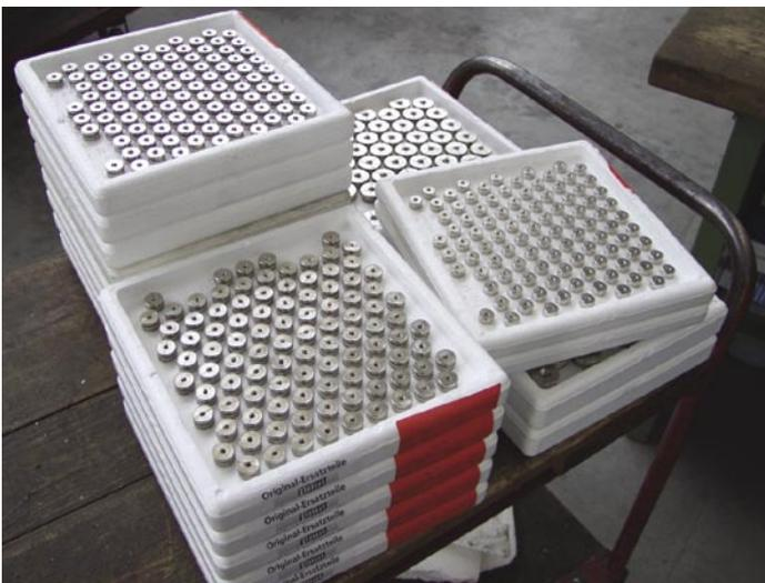
Anclajes de pretensado en bandejas de porexpan
