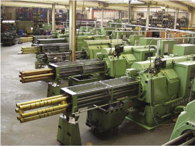
Tornos automáticos para la fabricación de cuñas de anclaje
