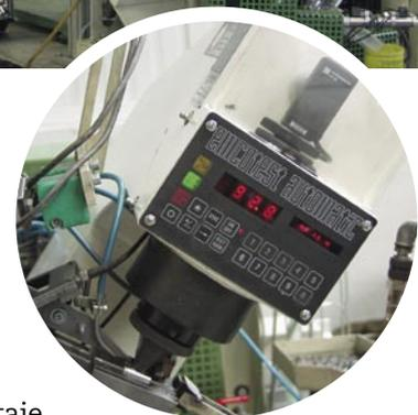
Máquina de comprobación y de montaje para dureza, afilado de dentado, medidas
