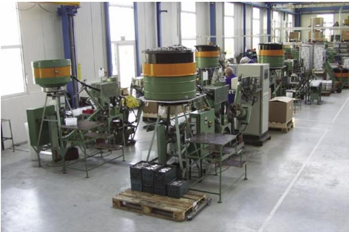
Máquinas automáticas de ensayo y montaje para cuñas de anclaje
